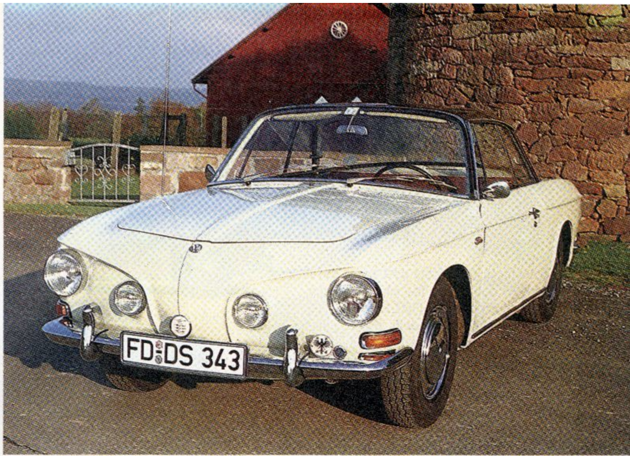
Durch das Zusammenziehen des Corvair-Gürtels in Bugmitte bekam der große Karmann seine typische „Nase“.
