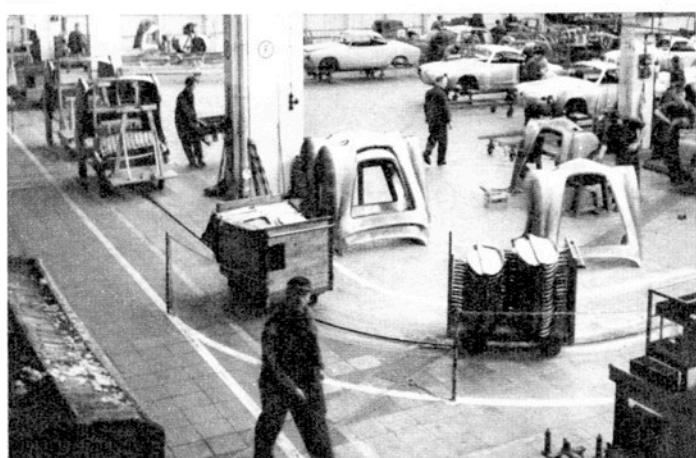
Durch die neuen Hallen von Karmann fährt eine Art automati- scher Straßenbahn: In so kurzen Abstän- den, daß jeder Stra- ßenbahn-Passagier in Entzücken versetzt würde, rollen kleine Wägelchen umher, gezogen von einer Kette, die in einer Schiene im Boden ver- läuft. Sie transportie- ren die einzelnen Teile zu deren Bestim- mungsorten (wobei unter „einzelnen Tei- len“ auch hin und wie- der eine Kiste Bier zu verstehen ist, die still vorbeizieht).
