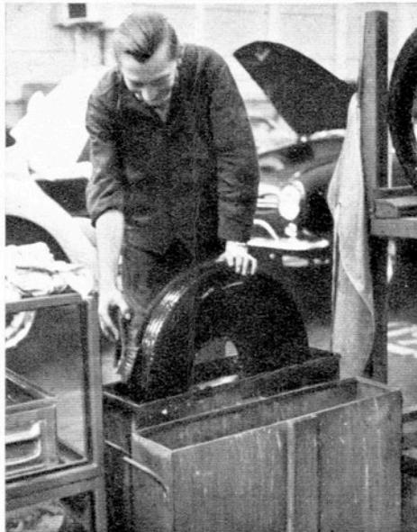
Damit die lieben Ghia-Fahrer auch stets warme Füßchen behalten, wird der Boden des Wagens mit dicken Filzplatten bepappet. Dieses Kleben geschieht aber keineswegs auf gutbürglerliche Weise mit einem Pinsel und einem großen Kleistertopf, nein, in einem modernen Werk wird selbst „Päpp“ mit einer Preßluft-Pistole aufgespritzt.
