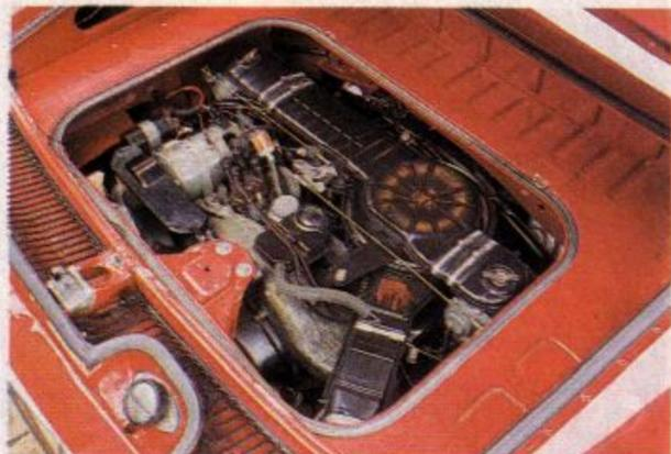
Is' der flach, Mann! Die Unterflur-Bauweise ermöglicht zwei (bescheidene) Kofferräume.
