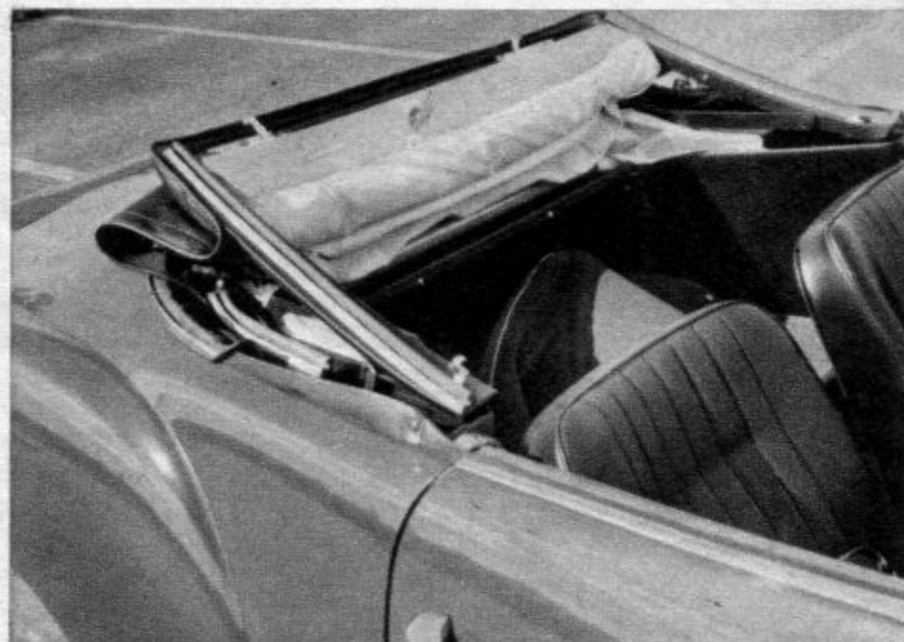
Bild links: Sitz- und Gepäckraumbreite hinten sind beim Cabrio durch die seitlichen Kästen fürs Verdeckgestänge eingeschränkt, der hintere Gepäckraum ist durch den Verdeckkasten niedriger als beim Coupé. Bild rechts: Das Verdeck des VW-Ghia ist nicht besonders fortschrittlich; es hat keine hinteren Seitenfenster wie früher DKW und jetzt Fiat 124 Spider, und es braucht viel Raum, ist aber nicht voll versenkbar. Bemerkenswert ist jedoch die sehr solide Gestängeausführung. Das Verdeck hat eine Innenverkleidung, einen regelrechten Dachhimmel und damit tadellose Isolierung gegen Geräusche und Kälte so gut wie bei einem Coupé-Aufsatz (Hardtop).
