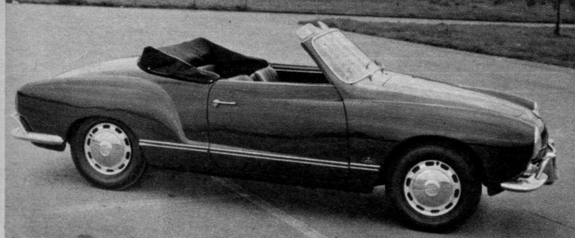
Bild links: Sitz- und Gepäckraumbreite hinten sind beim Cabrio durch die seitlichen Kästen fürs Verdeckgestänge eingeschränkt, der hintere Gepäckraum ist durch den Verdeckkasten niedriger als beim Coupé. Bild rechts: Das Verdeck des VW-Ghia ist nicht besonders fortschrittlich; es hat keine hinteren Seitenfenster wie früher DKW und jetzt Fiat 124 Spider, und es braucht viel Raum, ist aber nicht voll versenkbar. Bemerkenswert ist jedoch die sehr solide Gestängeausführung. Das Verdeck hat eine Innenverkleidung, einen regelrechten Dachhimmel und damit tadellose Isolierung gegen Geräusche und Kälte so gut wie bei einem Coupé-Aufsatz (Hardtop).
