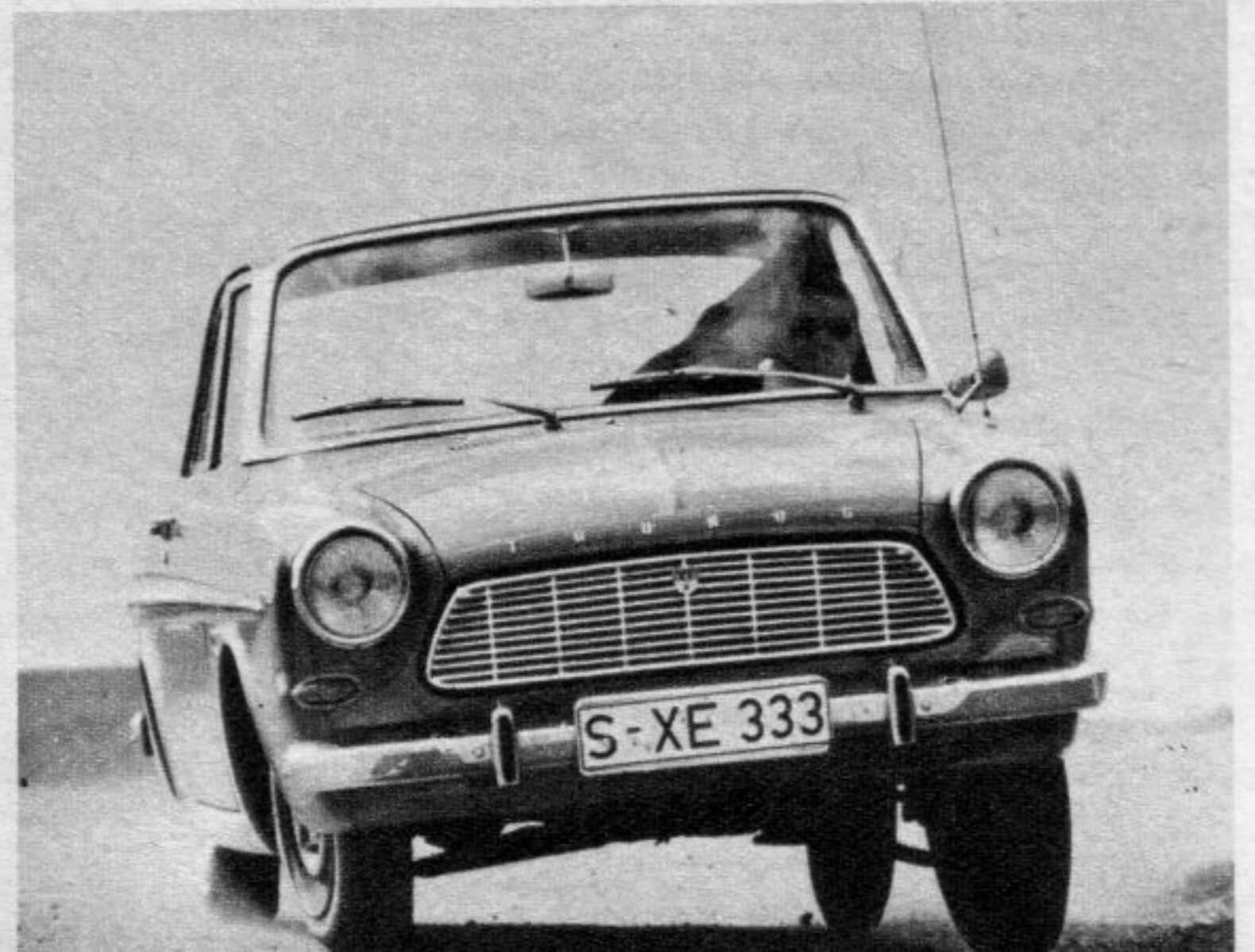
Der Ford 12 M ist stark untersteuernd ausgelegt. Er ist unhandlicher als die anderen Wagen und mühsamer um enge Kurven zu bringen, jedoch unproblematisch, wenn man ihn mit Kraft in die Kurve zwingt.
