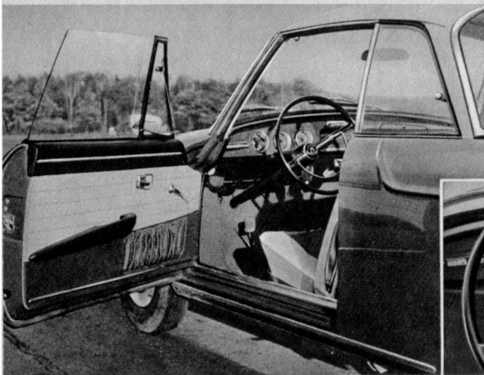
WEIT AUSLADENDE TüREN, vollversenkbare Seitenscheiben, mit Ausnahme der Schwenkfenster, dünne Windschutzscheibenpfosten. Die Armaturen (unten) sind gleich denen der Limousine.
