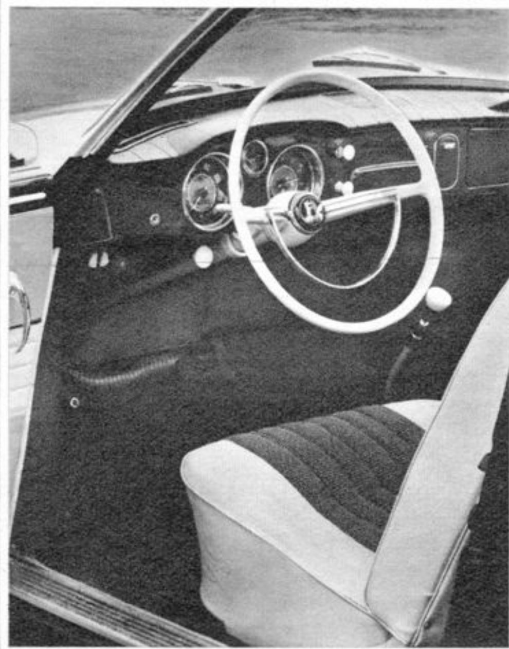
Der Karmann-Ghia hat das Lenkrad des normalen VW. Zur serienmäßigen Ausstattung gehören Lichtlupe, elektrische Uhr und Kraftstoffanzeige, außerdem wie auch beim normalen VW Scheibenwascher.
