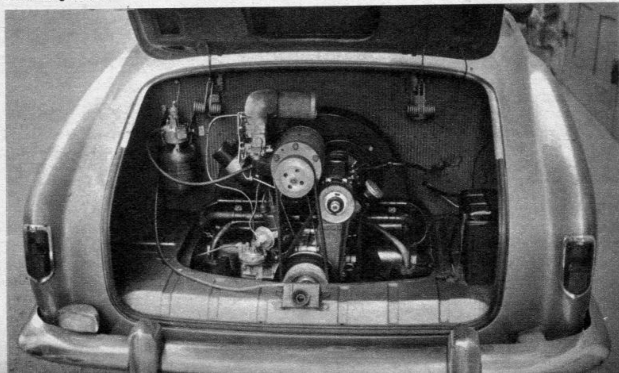
Das Judson-Gebläse wird ohne wesentliche Veränderungen am Motor montiert und über eine zusätzliche Riemenscheibe angetrieben.
